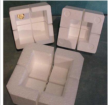
EPE Partikelschaum/ Particle foam
