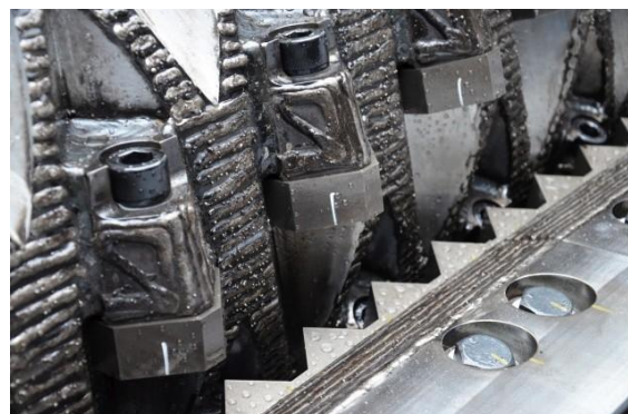
Шредер WEIMA с утопленными болтами. Ротор с внешними шестигранными болтами
