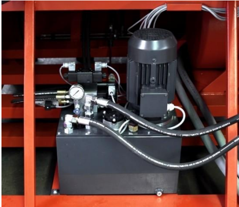
Пылезащищенный и ударопрочный гидравлический блок WEIMA
