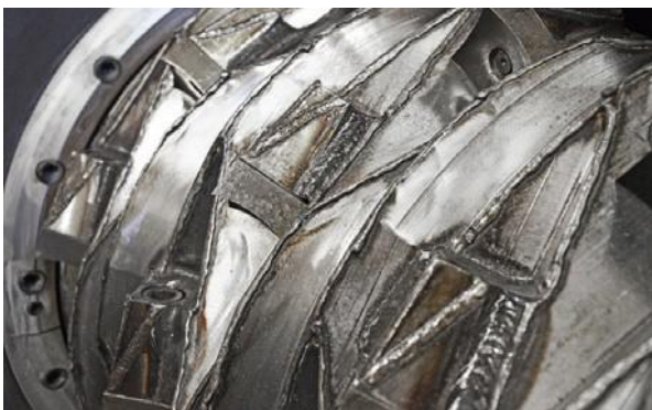
Шредер WEIMA с утопленными болтами. Ротор с внешними шестигранными болтами
