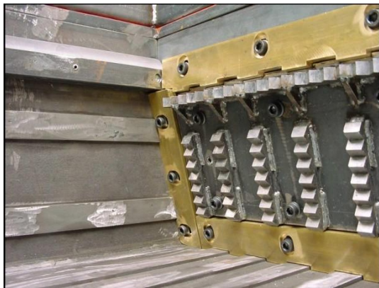
Гидравлический толкатель WEIMA с гребенчатой пластиной. Гидравлический толкатель WEIMA без гребенчатой пластины.
