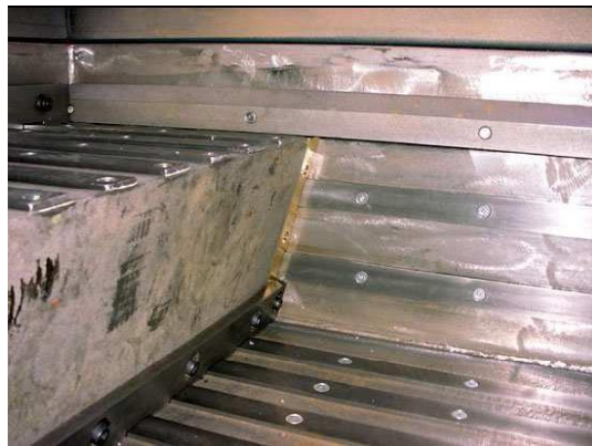
Гидравлический толкатель WEIMA с гребенчатой пластиной. Гидравлический толкатель WEIMA без гребенчатой пластины.
