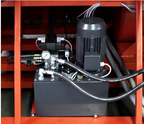
Пылезащищенный и ударопрочный гидравлический блок WEIMA
